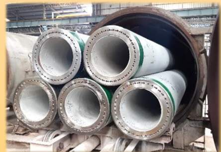
高溫高壓養生 (Autoclave curing)
