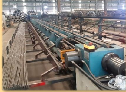
鋼棒剪裁 (Steel bar cutting)
