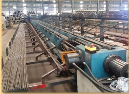
鋼棒剪裁 (Steel bar cutting)
