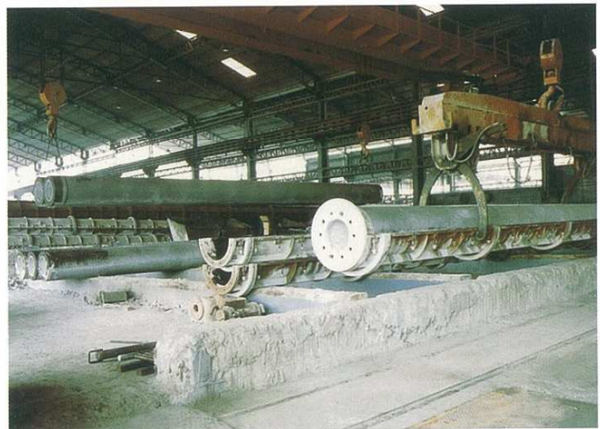
▲ 脫模 PILE REMOLDEN
